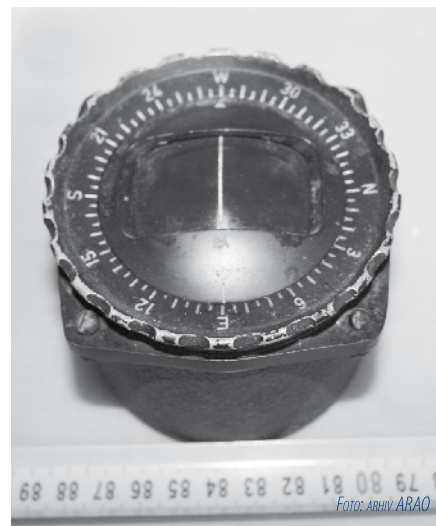
Neto masa letalskega instrumenta, v kovinskem ohišju valjaste oblike, znaša okoli 0,35 kg, v višino meri 80 mm, premer znaša 80 mm.
