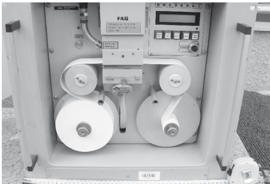
Merilnik FAG Kugelfischer, model FH 621+N – vsebuje originalni zaščitni vsebnik z vgrajenim zaprtim virom sevanja kripton-85.
