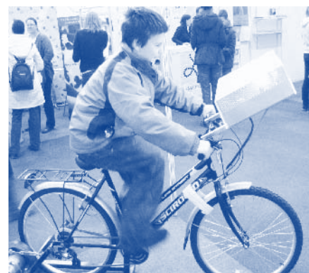
Elektrarna na človeški pogon (kolo z generatorjem in prikazovalnikom proizvedene moči)
